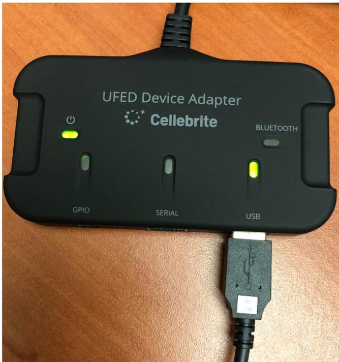
El adaptador del UFED 4PC, se utiliza para conectar el teléfono con la PC que ejecuta el UFED, esta imagen indica que la conexión con el teléfono se realiza sin problema y de forma exitosa, el led en verde así lo indica.
